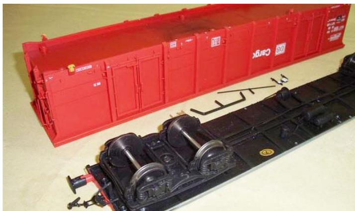
Die Last- und Bremsschalter am Wagenkasten sollen abgerissen werden und an die gegenüberliegende Seite umgebaut in die Nähe des Drehgestells. (Dabei soll das Unterrahmen 180 ° geschwenkt werden gegenüber der Oberbau)
