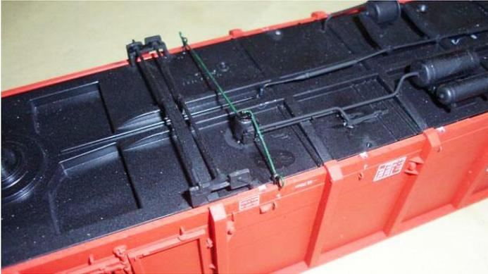
Ein Bremshebelsystem anbauen (für die Handräder), und kleinere Europäische Handräder mit 3 Speichen verwenden.
