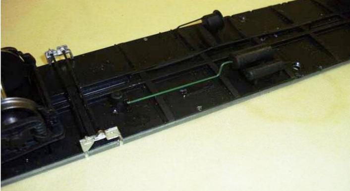
Das Ventil soll die richtige Stelle gegeben werden und verbunden mit Draht zu die Luftkessel.
